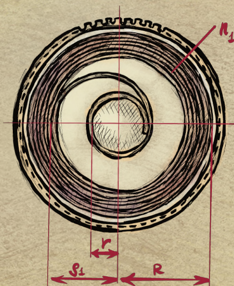
Рис. 4: Положение пружины в барабане в спущенном состоянии
