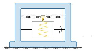
Для записи горизонтальных колебаний фундамента при землетрясении можно использовать прибор (виброграф), простейшая схема которого представлена на рисунке. К раме вибрографа прикреплены груз массы m с помощью двух пружин жёсткости k и вращающийся вокруг горизонтальной оси гладкий барабан. Запись колебаний на барабане происходит с помощью пера, закреплённого на грузе.
