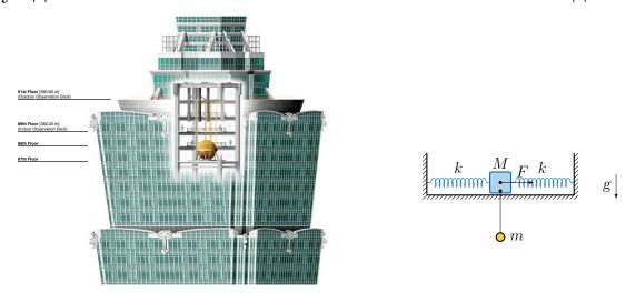
Известно, что небоскрёб «Тайбэй 101», расположенный в столице Тайваня — Тайбэе, сконструирован для эксплуатации в природных условиях, где нередки тайфуны и землетрясения. Для того чтобы противостоять сильным ветрам и предотвратить поперечные смещения башни небоскрёба, в ней установлен крупнейший инерционный демпфер колебаний — 660-тонный стальной маятник в виде шара.
